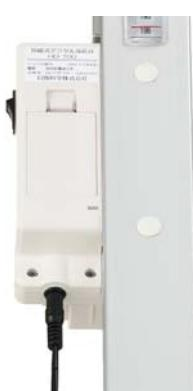
測定部下面のプラグ挿入口に、AC アダプタのプラグを差し込んでください。乾電池がセットされている場合、AC アダプタの電源供給に切り替わります。
