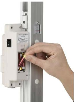
電池フタの上部のツメを下側へ押し、電池フタを取り外してください。
