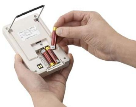
スタンドを上げ、電池フタの上部のツメを押し、電池フタを手前にスライドさせて取り外してください。
